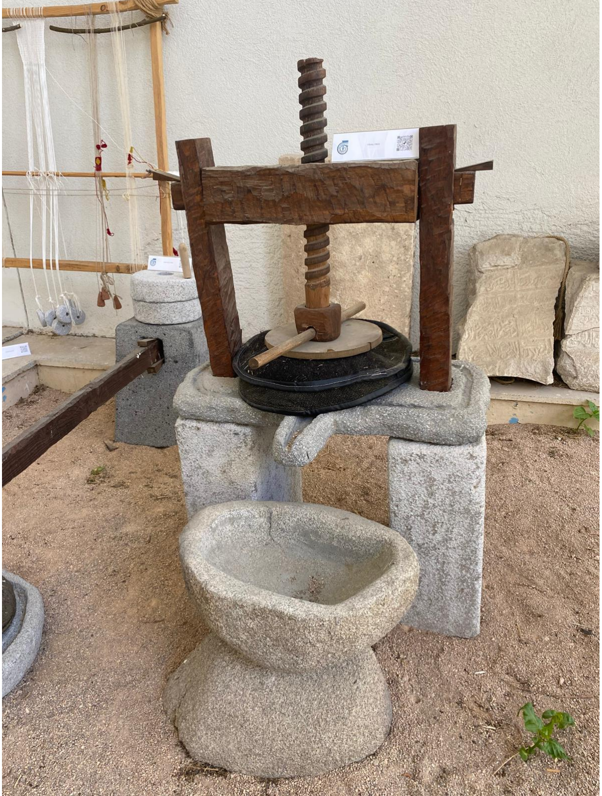
Zeytinyađı Üretiminde Kullanılan Vidalı Pres Sistemi
